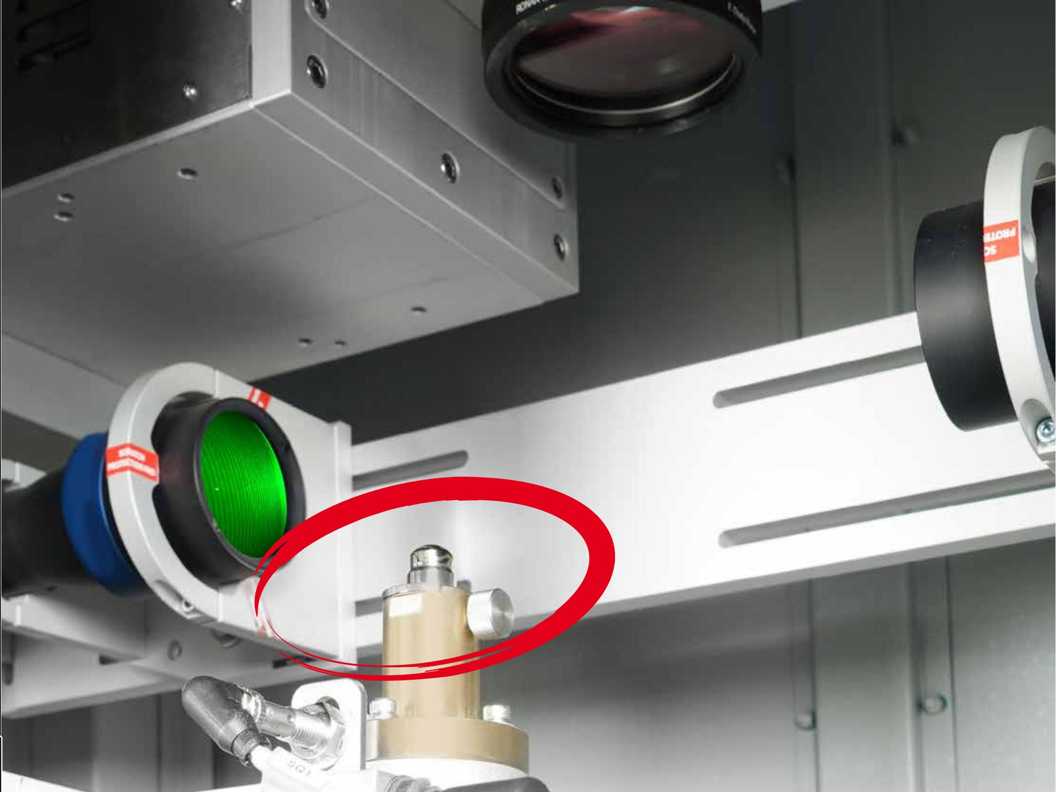
Sistema per la micromarcatura di lenti a contatto. Integra un sistema di visione ad alta risoluzione in condizione di rilevare il profilo della lente e un dispositivo di posizionamento automatico (precisione complessiva di 0,01 mm)
