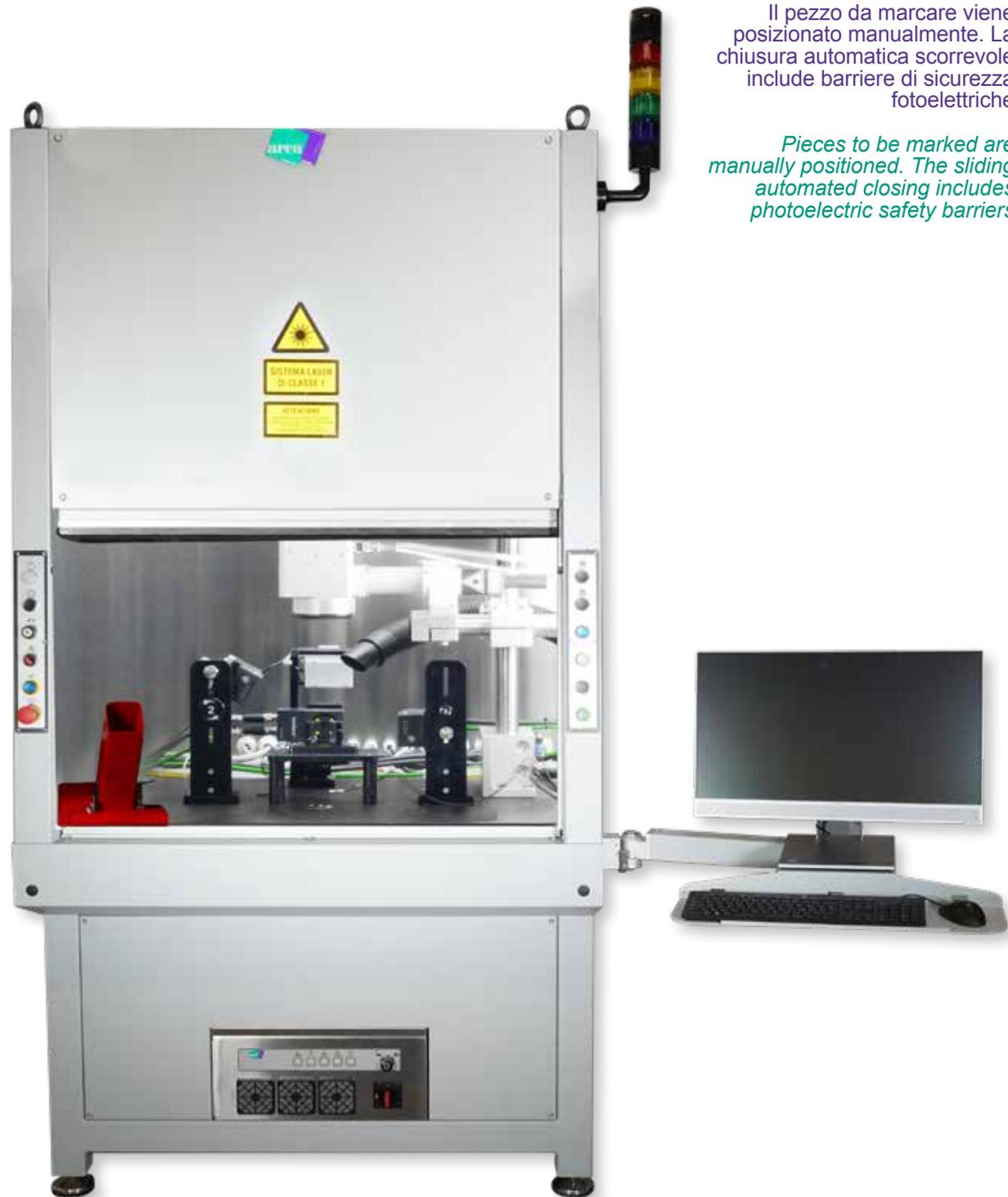
Il pezzo da marcare viene posizionato manualmente. La chiusura automatica scorrevole include barriere di sicurezza fotoelettriche
