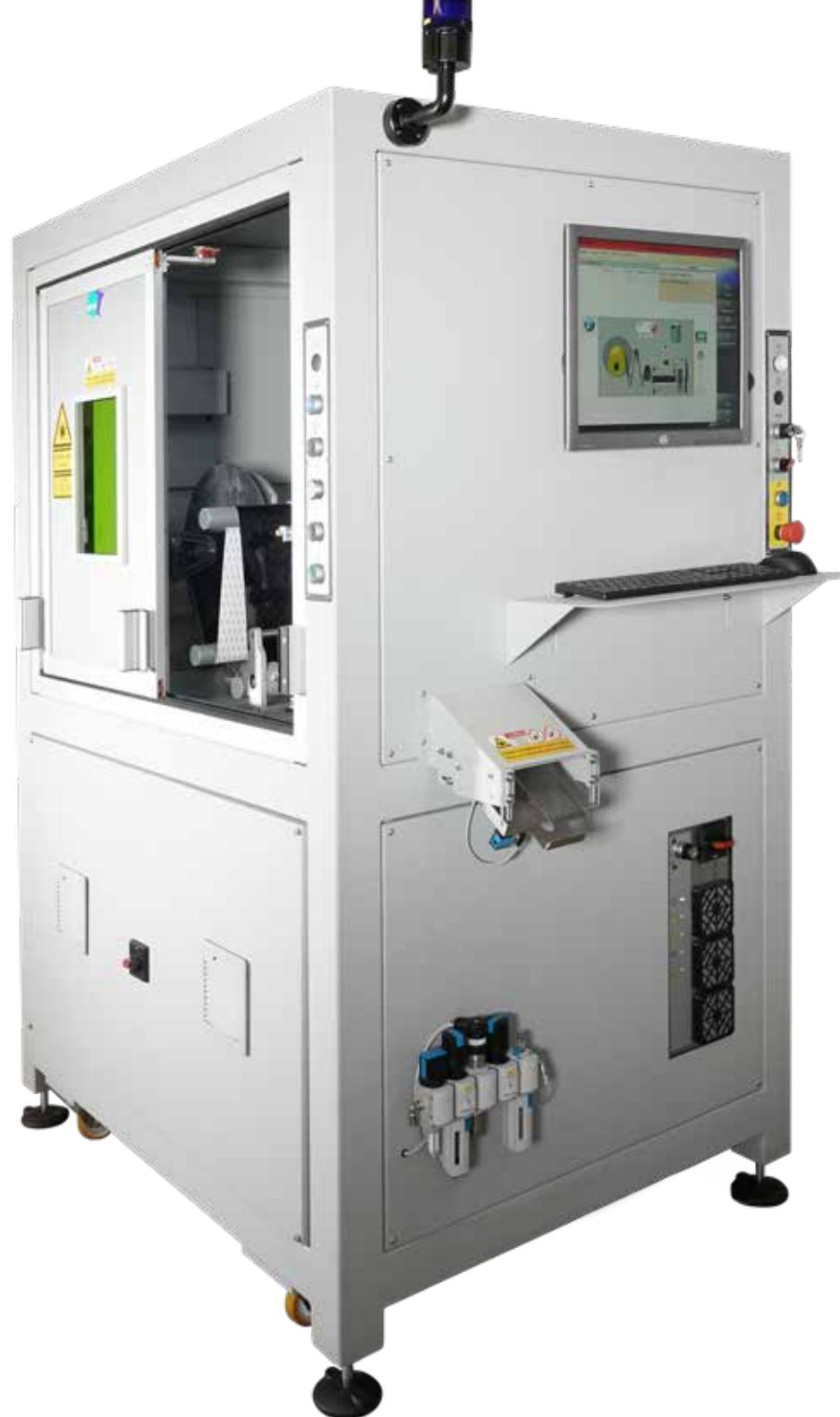
Sistema per la produzione di etichette auto-adesive, confezionate in fogli, mediante fustellatura e marcatura laser; tipicamente utilizzate nel settore automotive e ove conveniente l'applicazione manuale.
