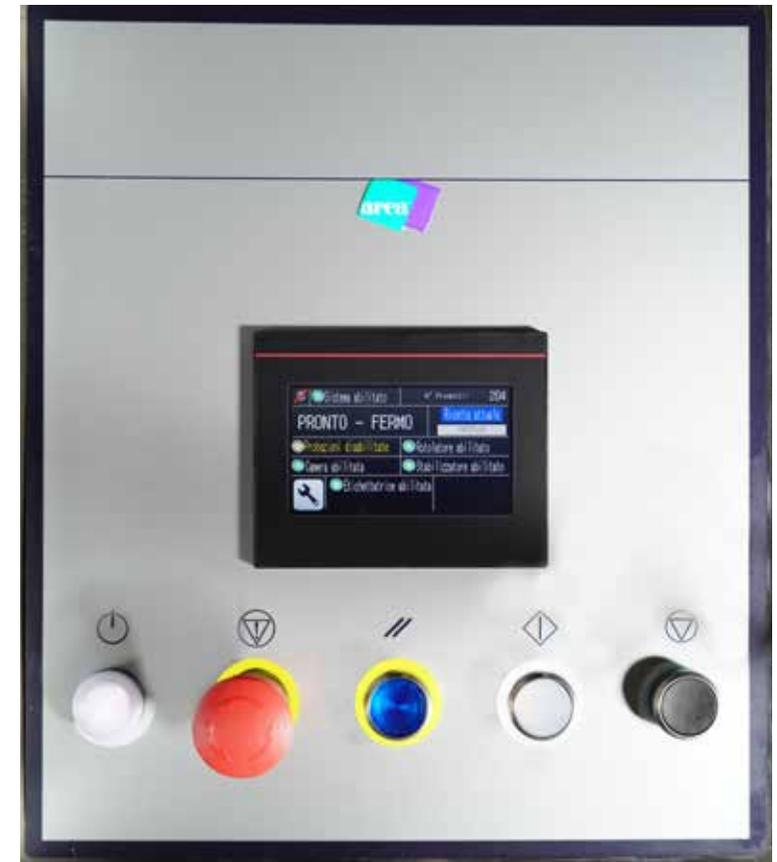
Interfaccia operatore su panel PC industriale 10" a colori, MS Windows Embedded, drive a stato solido (SSD). Grafica semplice e intuitiva con rappresentazione del layout macchina e localizzazione allarmi. Include tutte le funzioni fondamentali e inoltre:
