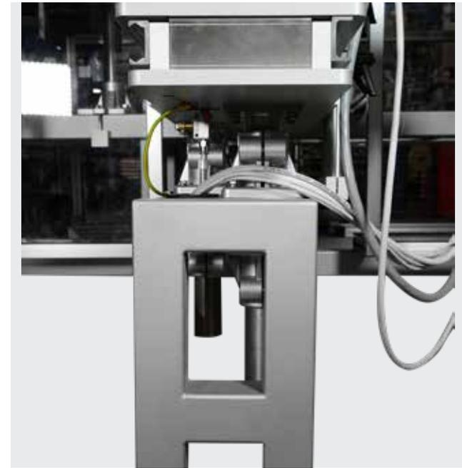
La slitta pneumatica consente l'estrazione dell'etichettatrice in allarme; indispensabile per l'agevole sostituzione del rotolo etichette esaurito. Grazie alla slitta, dopo il ripristino la macchina viene riportata nella posizione perfetta per il miglior funzionamento
