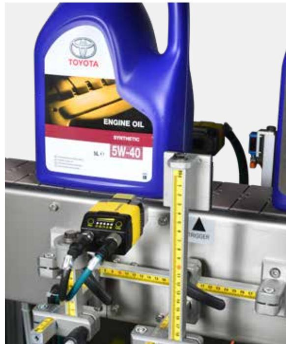
Controllo avvenuta etichettatura ed espulsore a soffio d'aria o a cilindro pneumatico
