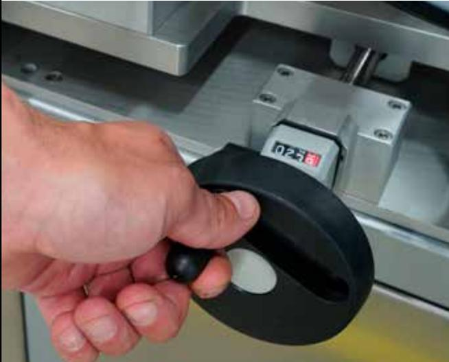
Cambio formato rapido. Una regolazione principale controlla, con un solo movimento, la larghezza del convogliatore e il posizionamento dell'inseritore, di codificatori, telecamere laterali, etichettatrici e adattatori sigilli. Regolazioni per "fine tuning" (per configurazioni particolari) con indicatori numerici di posizione e fissaggio di sicurezza
