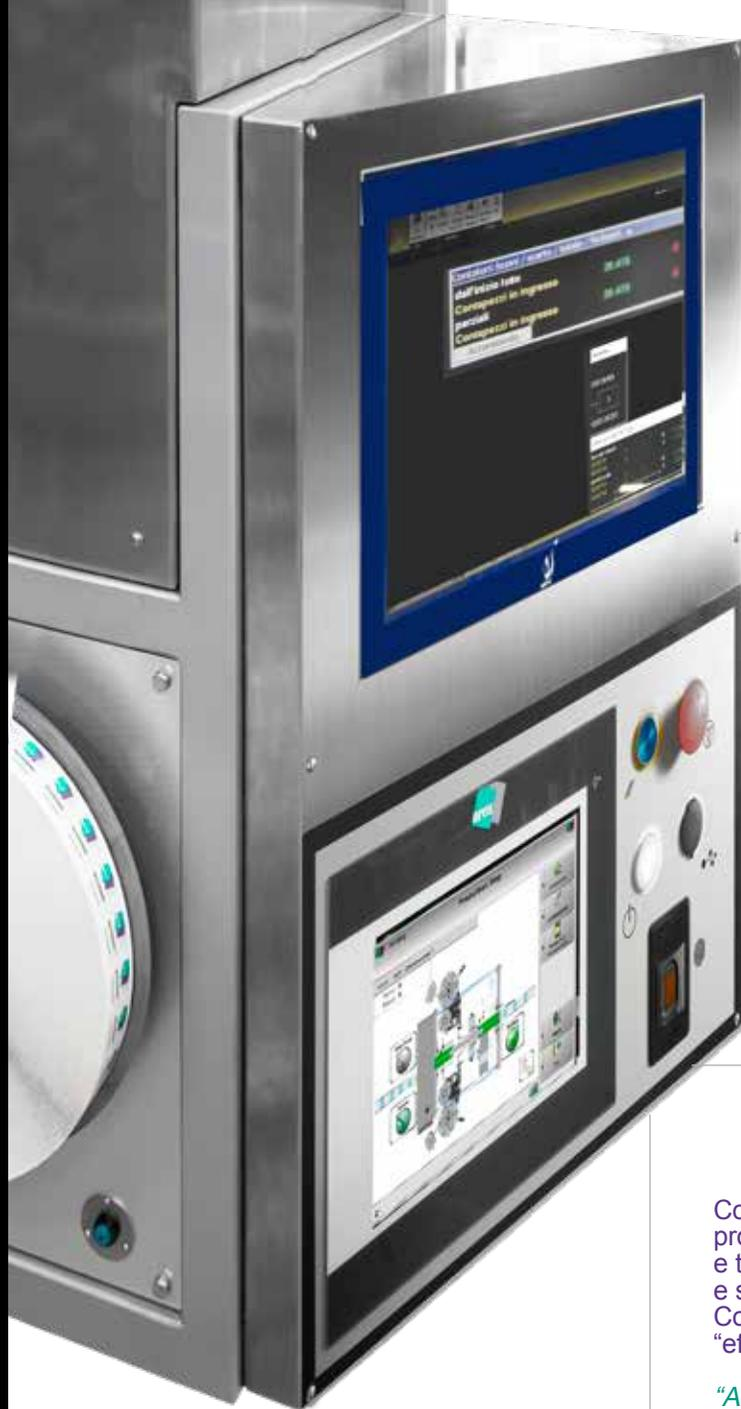
Il pannello di controllo (MMI) e il monitor del sistema di tracciabilità sono divisi per la migliore operatività: consultabili e utilizzabili contemporaneamente. Sono entrambi collocati in posizione ergonomica
