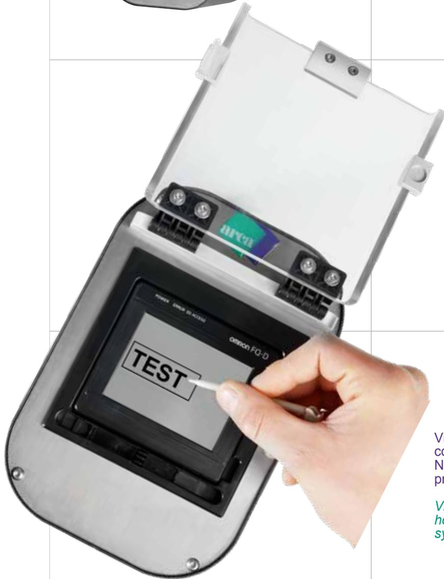
Visore del sensore di visione con alloggiamento metallico. Necessario solo per i sistemi privi di pc industriale
