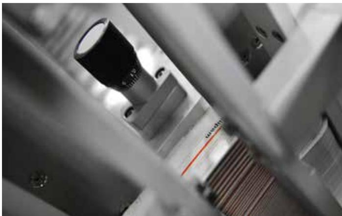
Magazzino verticale con controllo di minimo carico ed estrattore dotato di regolazione micrometrica dello spessore
