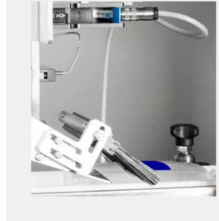
Sistema con modulo di stampa inkjet termico (compatibile HP). Ideale per etichettatura su sacche BFS (Blow Fill Seal)
