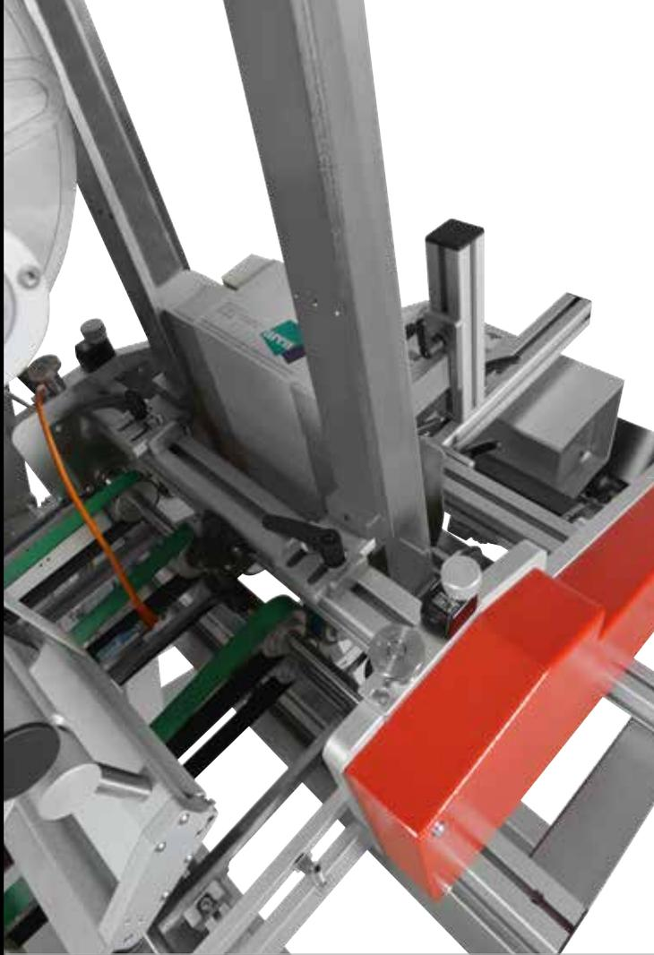
Magazzino verticale con controllo di minimo carico ed estrattore dotato di doppia regolazione micrometrica dello spessore
