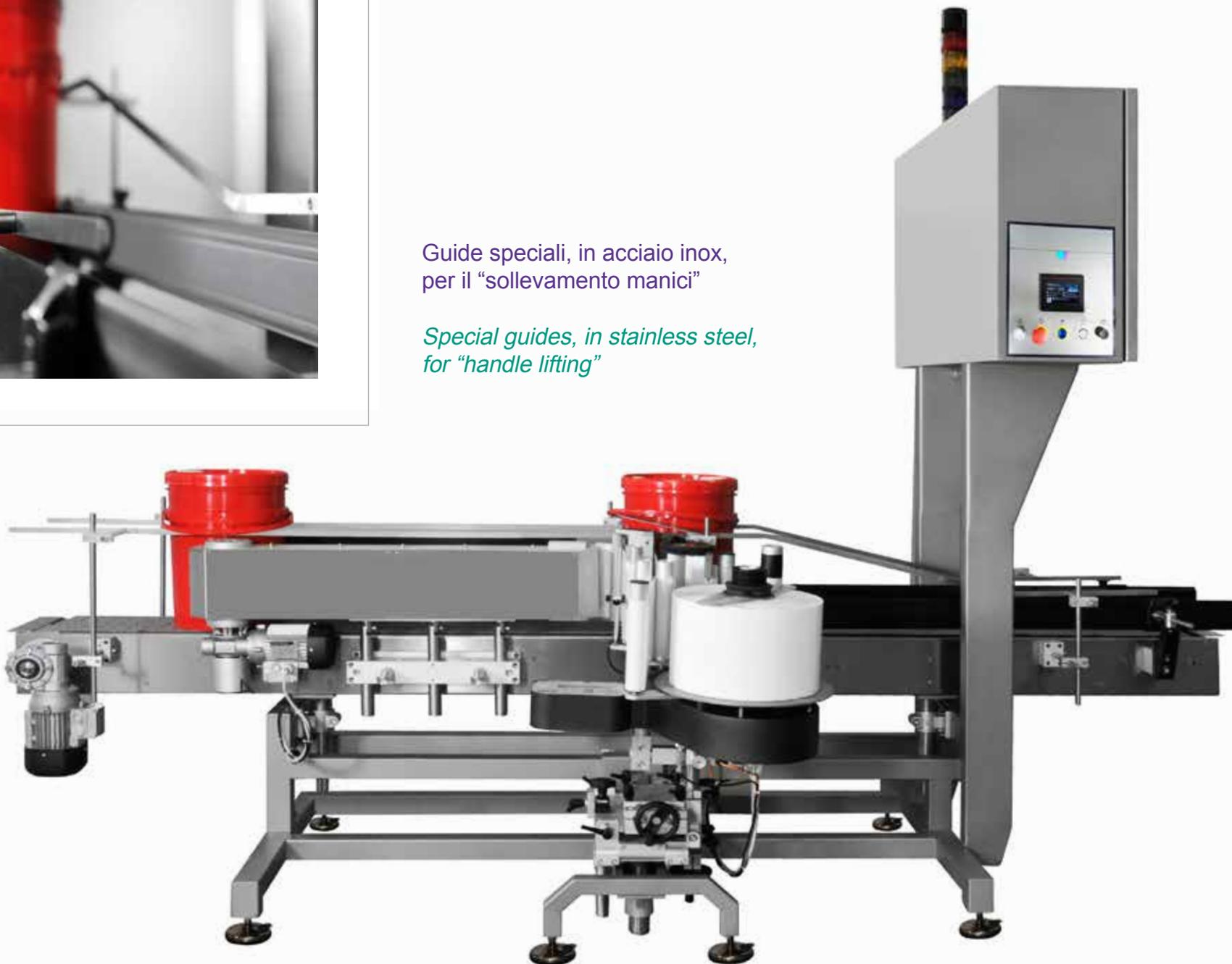
Non Stop coordina due etichettatrici collocate in batteria, garantendo la continuità di funzionamento.
