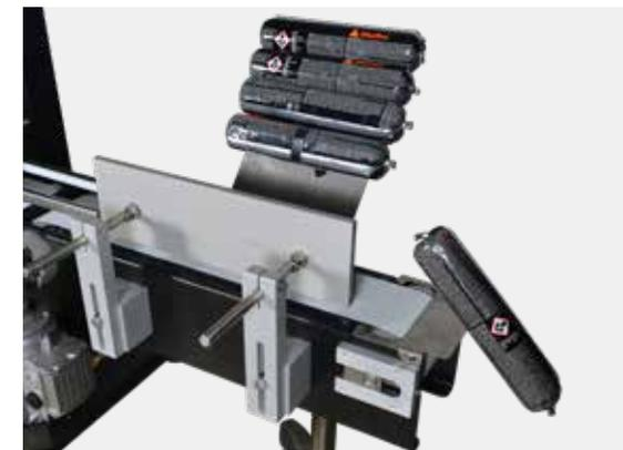
Prima sezione indipendente del convogliatore, con possibilità di distanziamento prodotti e inversione automatica del moto per espulsione prodotti difettosi
