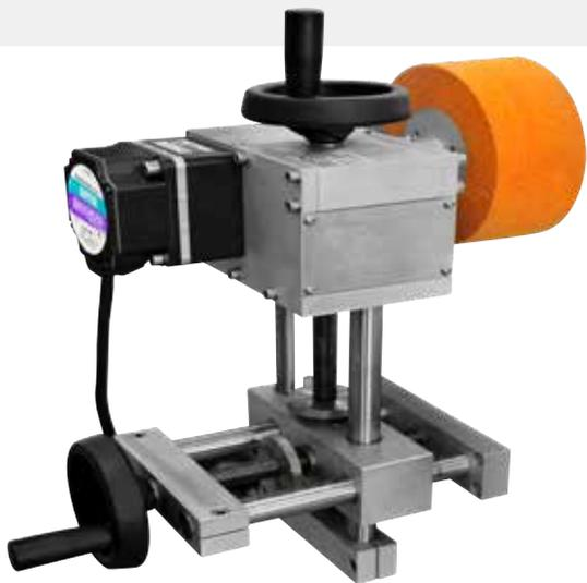
Adattatore motorizzato utilizzabile per l'adattamento su superfici critiche
