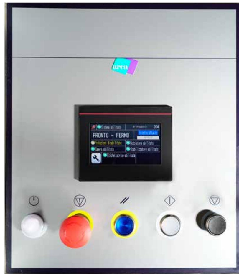
Interfaccia operatore su panel PC industriale 10" a colori, MS Windows Embedded, drive a stato solido (SSD). Grafica semplice e intuitiva con rappresentazione del layout macchina e localizzazione allarmi. Include tutte le funzioni fondamentali e inoltre:
