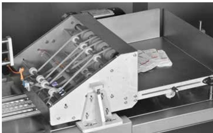
Espulsore meccanico ad alta velocità con contenitore di raccolta. Apparta i prodotti non etichettati o con codice non leggibile o non conforme al prodotto impostato
