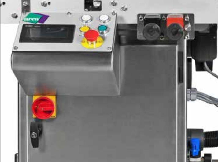
Il pannello di controllo con display touchscreen a colori e le principali regolazioni sono in posizione ergonomica. L'armadio dell'impianto elettrico è facilmente accessibile dal lato anteriore del sistema
