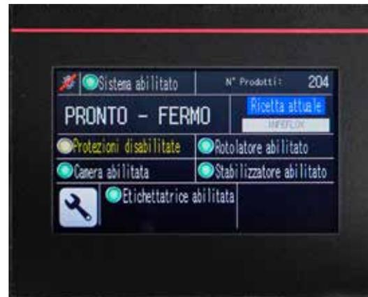
I sistemi più completi sono dotati di MMI, touch screen a colori. A richiesta anche conforme CFR 21 Part 11 e completa delle funzionalità più avanzate
