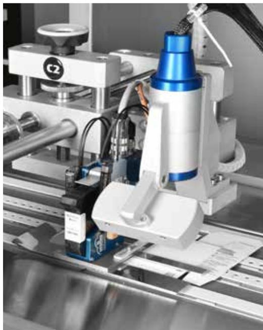
Moduli di stampa a getto di inchiostro termico (tecnologia HP) per la stampa sull'astuccio di testi e codici a barre (anche 2D). Fino a 4 testine per una più ampia superficie di stampa. Un'unica regolazione consente il posizionamento anche dell'eventuale sistema di visione per la verifica della stampa
