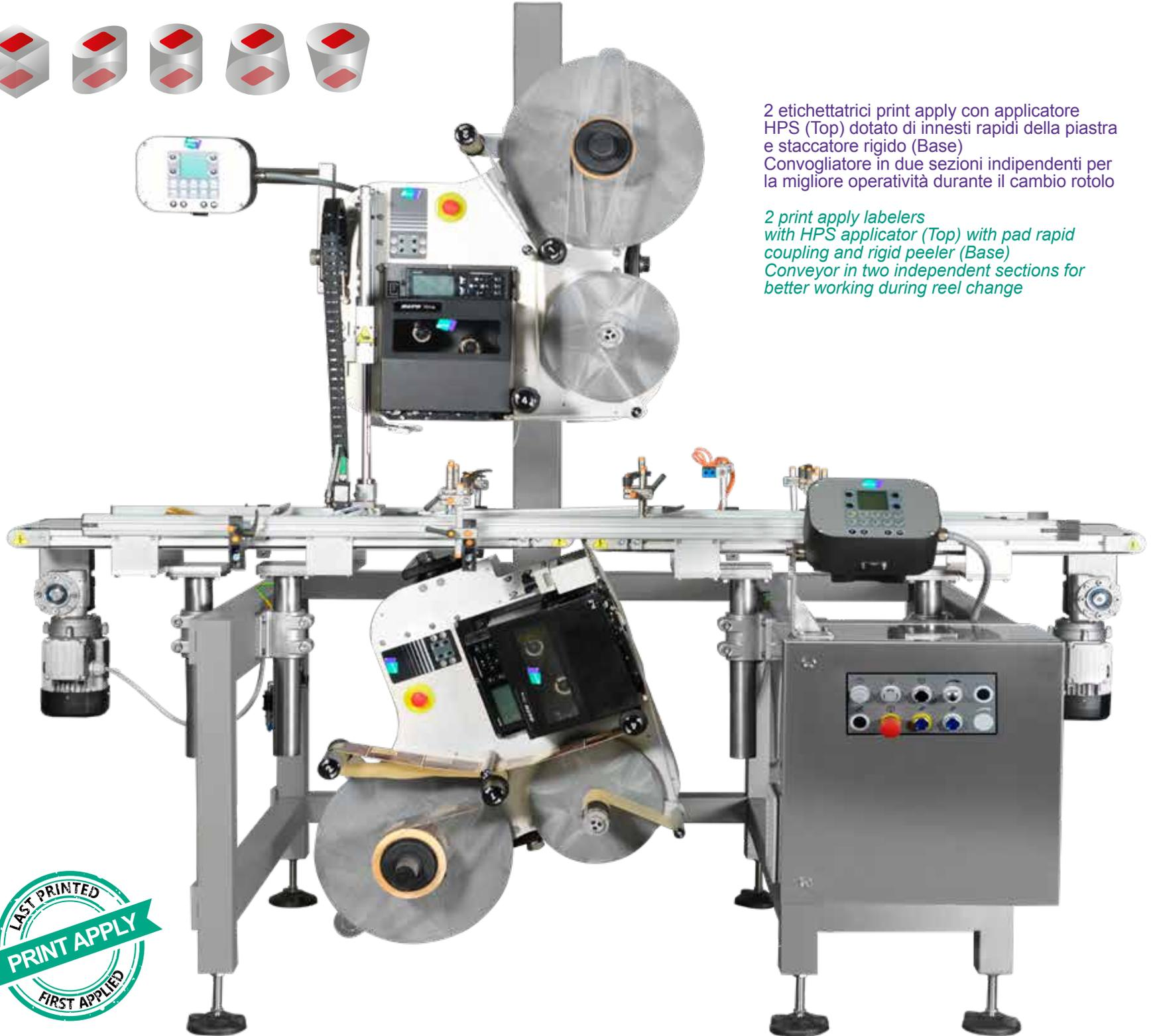
2 etichettatrici print apply con applicatore HPS (Top) dotato di innesti rapidi della piastra e staccatore rigido (Base)
