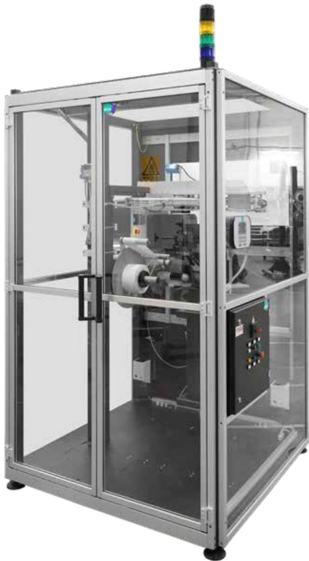
Struttura di sostegno Side con una protezione antinfortunistica in policarbonato trasparente antiurto. In alternativa, può essere realizzata con rete metallica nera
