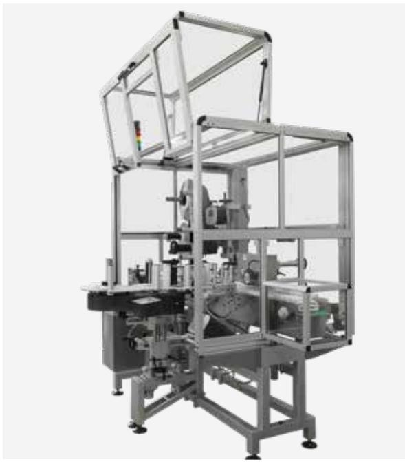
Alloggiamenti "multiformato" per l'etichettatura di precisione con sistemi a caricamento manuale. E' possibile alloggiare più prodotti simili, nel medesimo alloggiamento, riducendo i tempi di cambio formato
