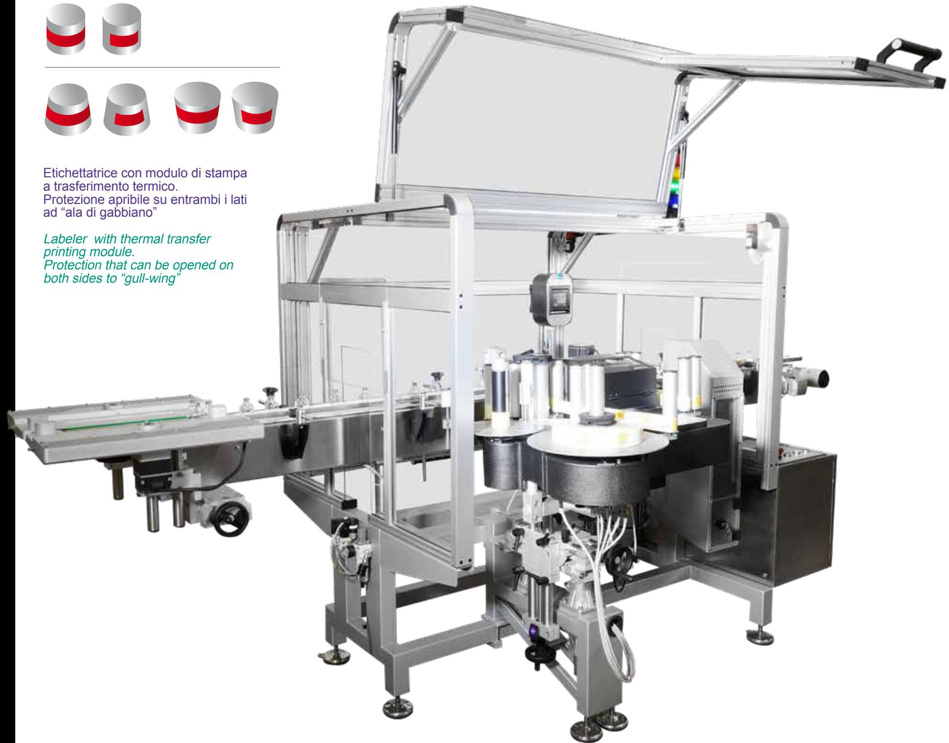
Il sistema di etichettatura è normalmente inserito nella linea di produzione automatica. In alternativa, può essere alimentato da una tavola rotante a caricamento manuale; lo scarico può essere sulla linea produttiva o su una seconda tavola rotante o su un tratto di accumulo lineare "controllato" (start e stop intelligente), sempre per scarico manuale
