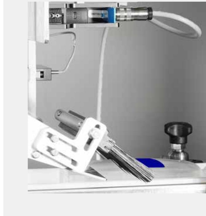
Sistema con modulo di stampa inkjet termico (compatibile HP). Ideale per etichettatura su sacche BFS (Blow Fill Seal)
