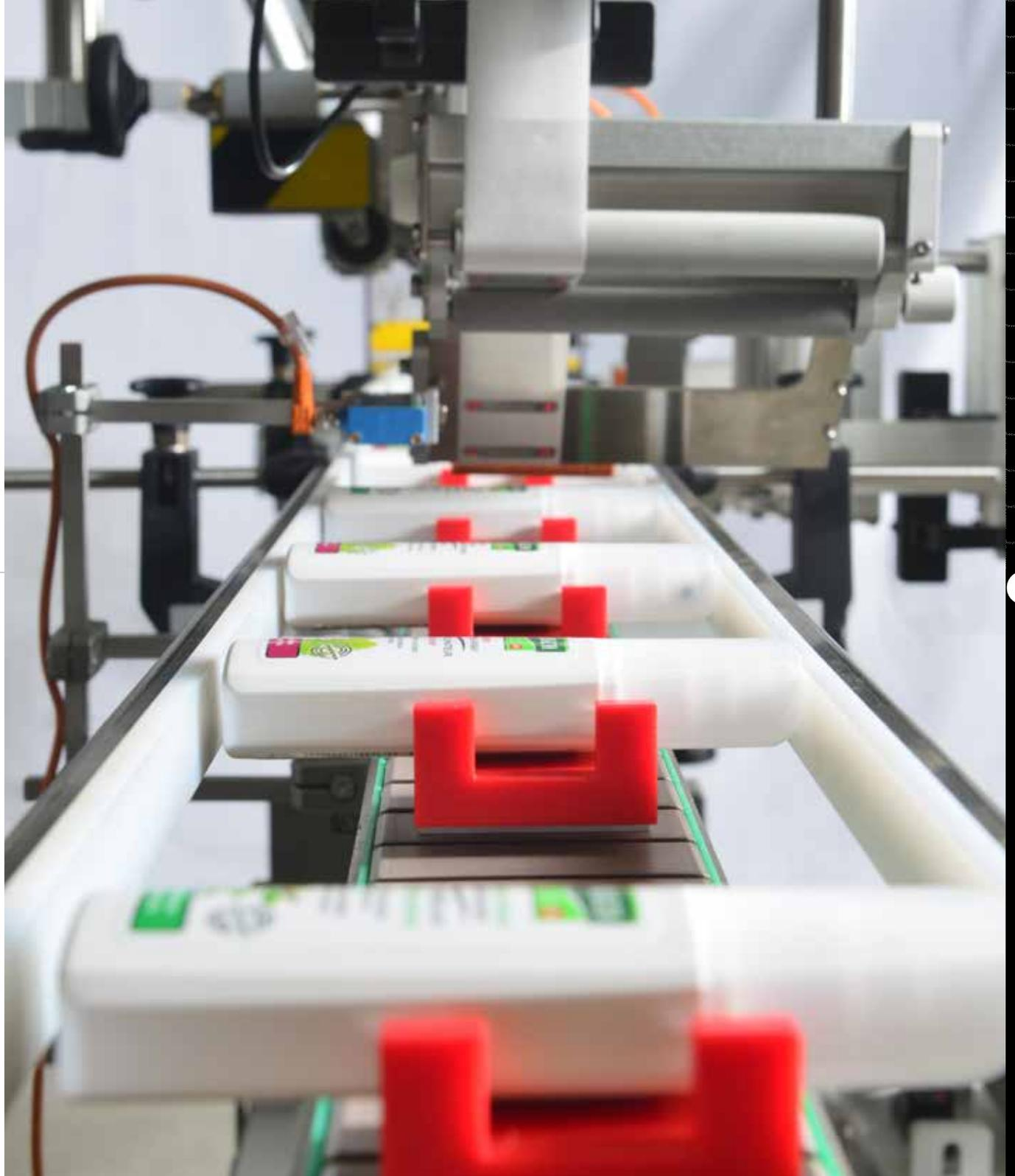
Un gamma completa di etichettatrici e print apply (ultima etichetta stampata, prima applicata) per ogni esigenza. Equipaggiabili, in funzione della tipologia di applicazione, con vari staccatori "a contatto" o con applicatori pneumatici per l'etichettatura a soffio d'aria.
