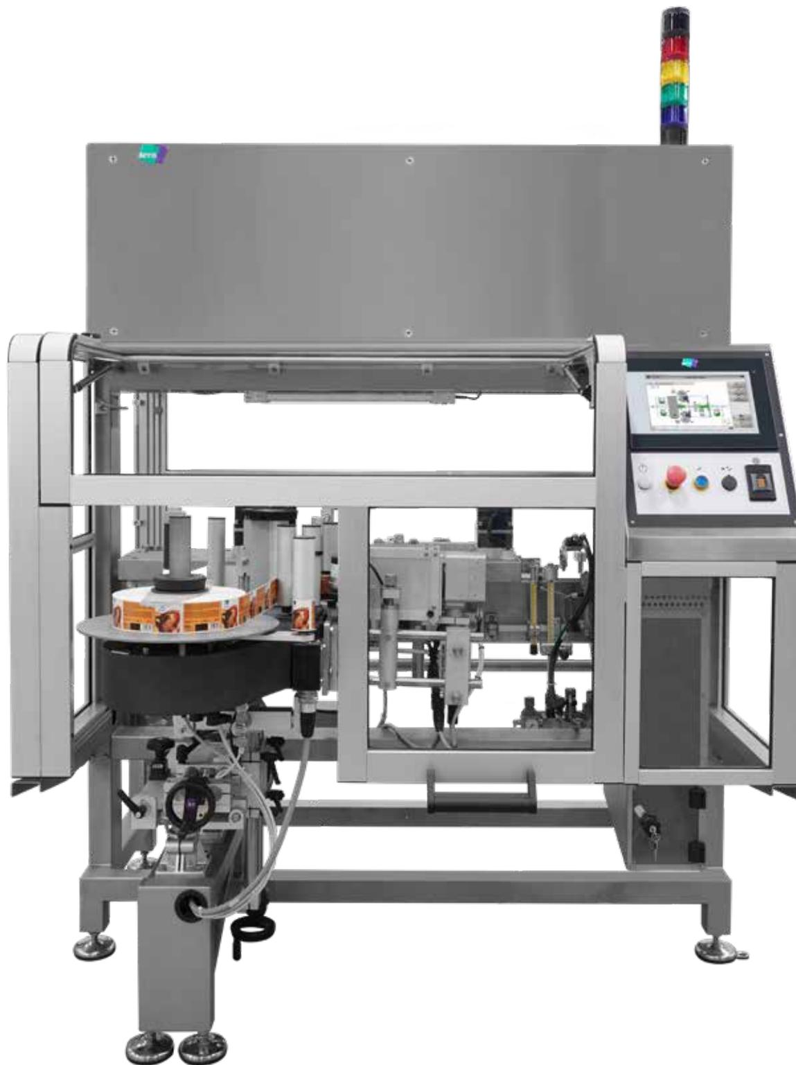
Sistema compatto monolaterale ("a balcone"). Tutte le regolazioni sono rinviate sul lato operatore. La struttura "open frame" facilita le operazioni di pulizia
